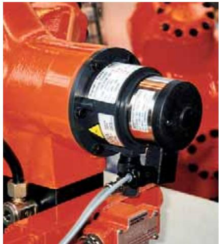
Klassische Kombination aus Drehimpulsgeber und Analog-Tacho an einem Hydraulikantrieb
