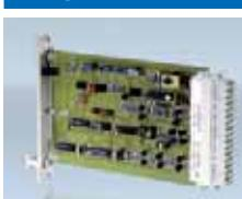
Bipolarer f/A-Konverter zur Frequenz-Analog-Wandlung
